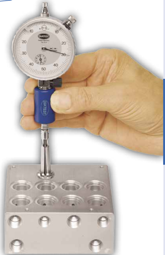
Tastkopf in Aktion Split-ball probe in action
