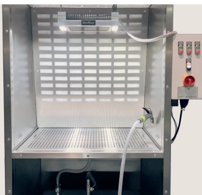
Prüfkammer für Prüflinge bis ca. 500 mm / 50 kg
