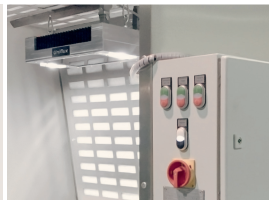
UV-/Weißlichtbeleuchtung, Bedienfeld und Luftfiltermatten
